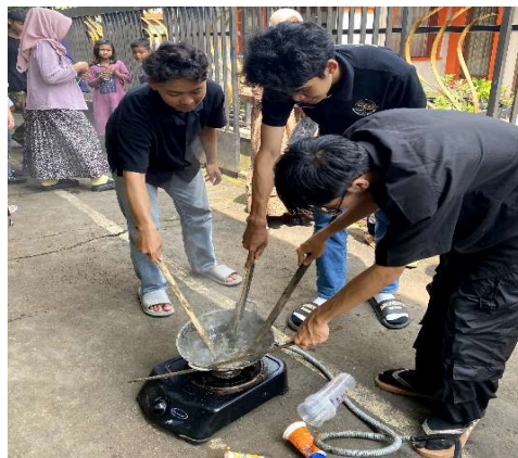
Gambar 5. Demonstrasi Pembuatan Paving Block dari Sampah Plastik
