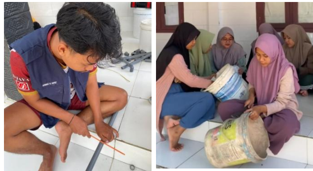
Gambar 3. pemotongan pipa paralon dan pengampelasan bekas tong cat
