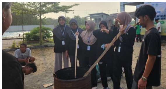
Gambar 3. Proses pencampuran bahan pasir dan oli bekas
