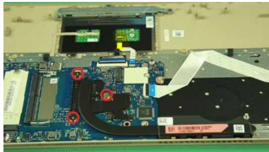
Gambar 9. Melepas Sekrup Heatsink Laptop
