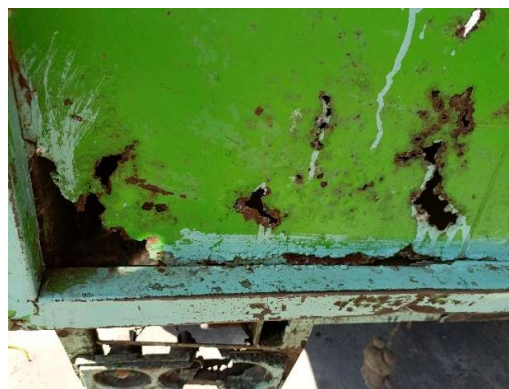
Gambar 9. Korosi pada bang kendaraan pengangkut sampah
