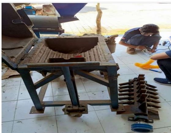
Gambar 15. Pembongkaran Mesin Pencacah
