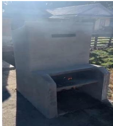
Gambar 5. Proses uji coba pembakaran sampah menggunakan INSAF
