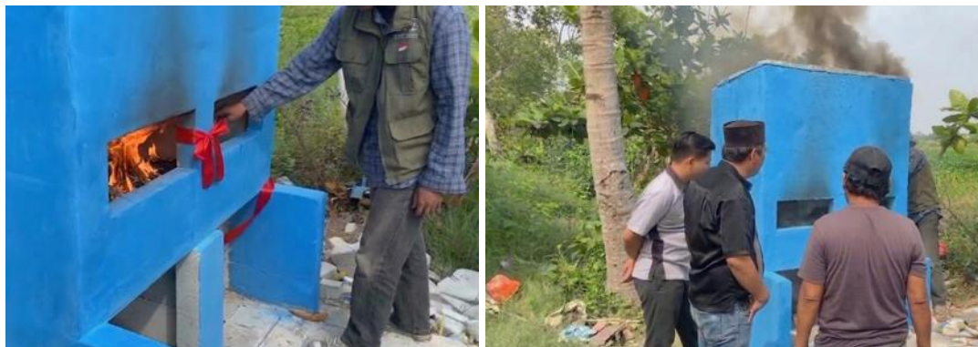
Gambar 5. Uji Coba Pembakaran Sampah Menggunakan Rocket Stove
