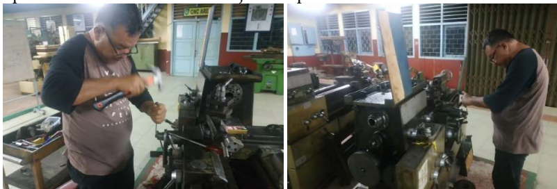
Gambar 4. Perbaikan eretan melintang.
