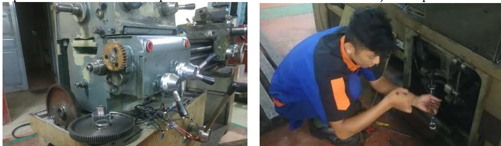
(a) Perbaikan end gearing
