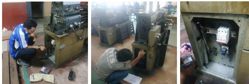
Gambar 7. Perbaikan sistem kelistrikan mesin
