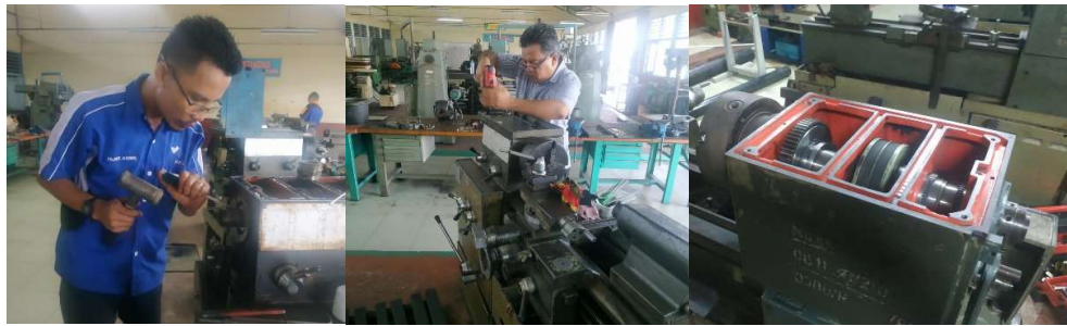
Gambar 5. Perbaikan spindle gearbox.
